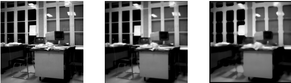
Figure 14 : A gauche l'image originale, au milieu l'image filtrée par un filtre médian (3x3) et à droite un (7x7)
