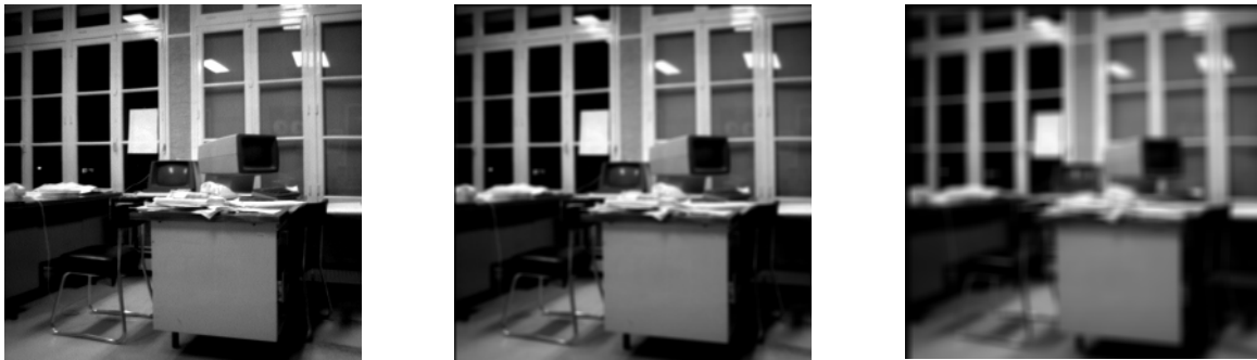
Figure 12 : A gauche l'image originale, au milieu son image filtrée par un filtre moyenneur (3x3) et à droite un filtre (7x7)
