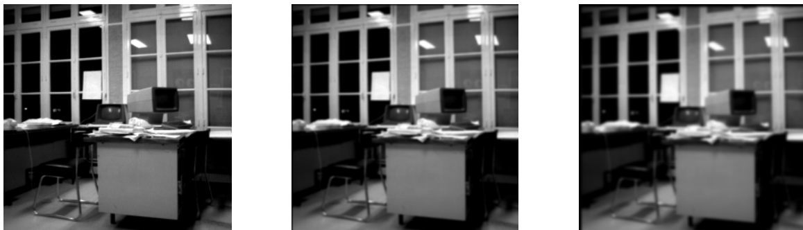
Figure 13 : A gauche l'image originale, au milieu son image filtrée par un filtre smooth(3x3) et à droite un (7x7)
