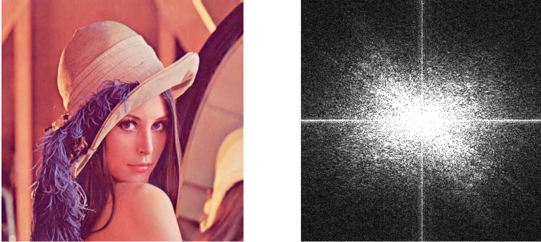
Figure 1 : A gauche une image naturelle. A droite le module de sa transformée de Fourier
