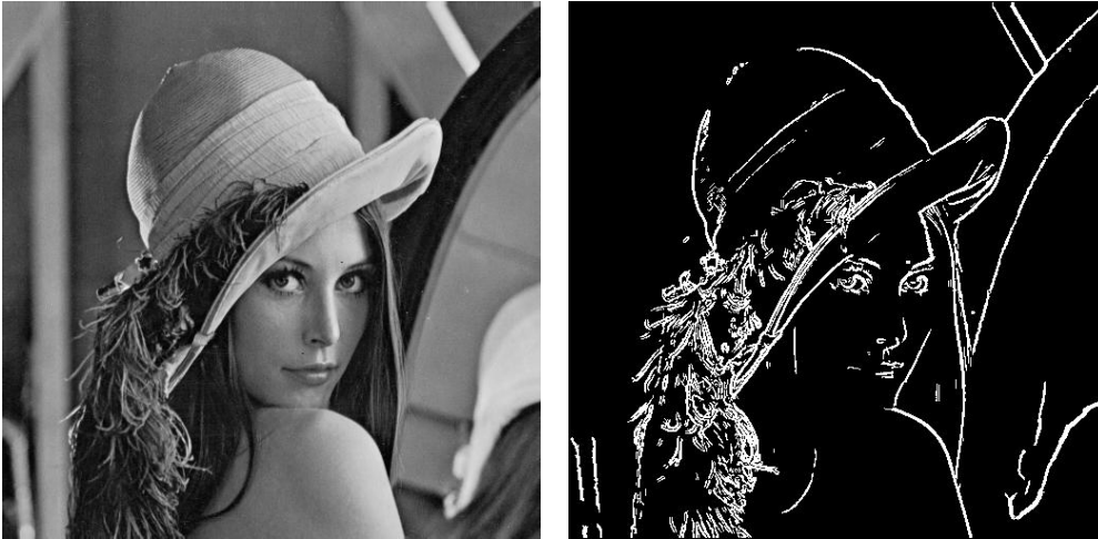
Figure 37 : Exemple d'image seuillée par hystéresis avec les seuils 44 et 60
